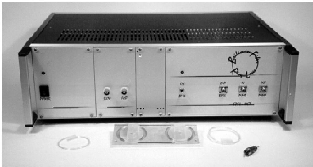
Figure 8-12: Vue du prototype de source laser Brillouin réalisé pour Ascom Tech, ainsi que de l'enseinte thermique utilisée contenant le résonateur en anneau.
